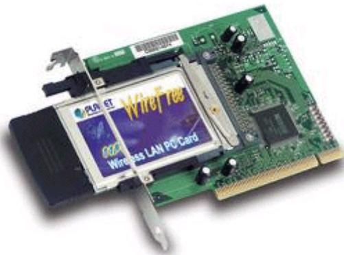
O bien tarjetas **PCI puente** donde se puede insertar la tarjeta PCMCIA Wireless que se utiliza en los portátiles, de esta manera una misma tarjeta PCMCIA puede tener dos usos.
